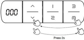
Drücken Sie die Taste „M“, bis auf dem Display „s-“ erscheint, lassen Sie anschließend die Taste los. Drücken Sie die Abwärtstaste („Nach unten“), nachdem das Display zu blinken beginnt, lassen Sie die Taste los. Drücken Sie erneut die Taste „M“ für 2 Sekunden. Sobald „000“ auf dem Display erscheint, ist die Einstellung abgeschlossen.
