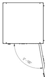
4 x pieds de nivellement réglables par le haut à l'aide d'une clé hexagonale, taille SW6
