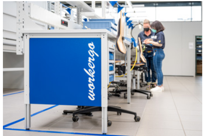
BU: Das ergonomische Arbeitsplatzsystem Workergo von Bedrunka + Hirth, hier in der bei Kurt Semrau eingesetzten 4-Fuß-Version, bietet drei verschiedene Formen der Höhenverstellbarkeit.
