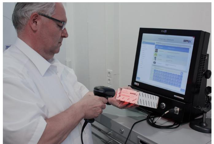
Per Barcode-Scanner werden Waren in das System eingelesen. Der TSM® kontrolliert den Lagerbestand, bestellt selbstständig und verhindert so etwa Maschinenstillstandzeiten.
