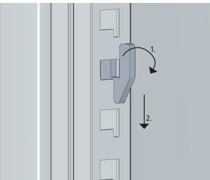
3. Den H-Fachbodenhalter nach rechts drehen und nach unten in den vorgesehenen Schlitz einschieben. Schritt 1-3 auf der linken und der rechten Seite je zwei mal durchführen.
