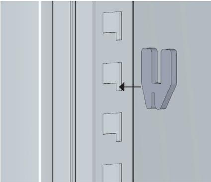
1. Die schmale Seite des H-Fachbodenhalters muss parallel zum Profil zeigen.
