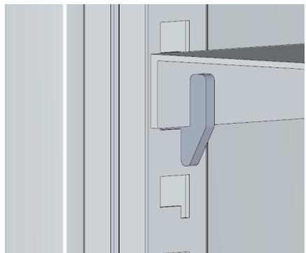
4. Nun den Fachboden auf die H-Fachbodenhalter legen und den Fachboden etwas nach unten drücken.
