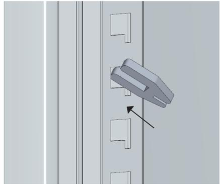
2. Den H-Fachbodenhalter diagonal in eine der Öffnungen im Profil einlegen. Alle vier H-Fachbodenhalter müssen auf gleicher Höhe angebracht werden.
