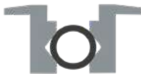
Horizontale 120°-Keilrille zum Einspannen von Rohren und anderen runden Werkstücken
