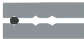
Drei vertikale Keilrillen von 100°, 120° und 130° zum Einspannen von Rohren und anderen runden Werkstücken
