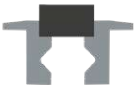
90°-Ausparung oben zum Einspannen von Flacheisen beim Markieren oder Ankörnen.
