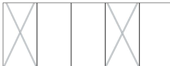
Für das 1. und 4. Feld ist ein Diagonalkreuz oder eine Rückwand erforderlich. Beispiele zur Anordnung der Diagonalkreuze/Rückwände.
