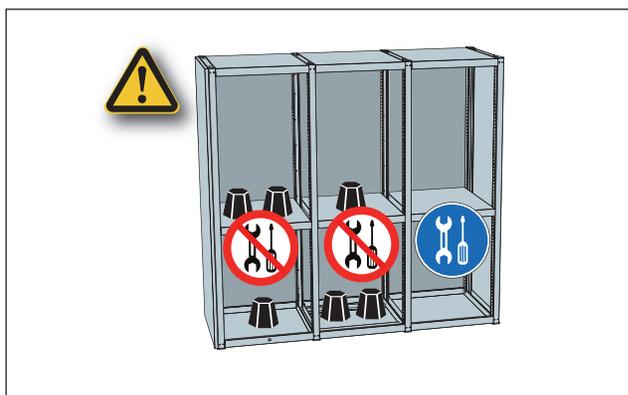
Nur im unbeladenen Zustand demontieren/ reparieren
