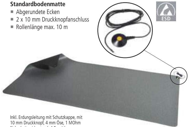
Inkl. Erdungsleitung mit Schutzkappe, mit 10 mm Druckknopf, 4 mm Öse, 1 MOhm Sicherheitswiderstand, 4,5 m Länge
