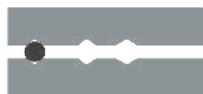
Trois rainures en V verticales de 100°, 120° et 130° pour le serrage des tuyaux et autres pièces rondes
